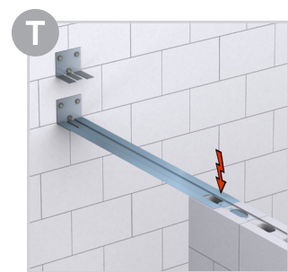
Aukko rajoittuu valmiiseen rakenteeseen (T- tai L-liitos).
